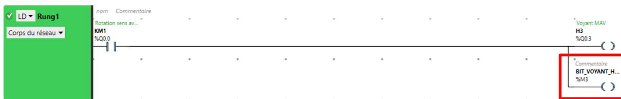
Bit internal %M3 untuk menghubungkan HMI LED H3 ke PLC.
