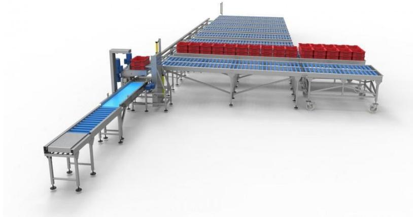
Perangkat otomatis untuk menyortir kotak dengan dua ukuran berbeda terdiri dari sabuk konveyor pengumpan kotak, tiga pendorong dan dua sabuk konveyor pelepasan. Pendorong 1 mendorong kotak kecil di depan pendorong 2, yang pada gilirannya memiringkannya ke sabuk pembuangan 2, sedangkan kotak besar didorong di depan pendorong 3, yang membuangnya ke sabuk 3. Untuk pemilihan peti, alat pendeteksi di depan plunger 1 mengenali jenis peti yang tersedia.
