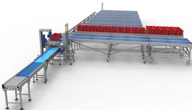
Perangkat otomatis untuk menyortir peti kemas dengan dua ukuran berbeda terdiri dari sabuk konveuor pemasukan peti kemas, tiga pendorong, dan dua sabuk konveyor pelepasan. Setiap sabuk mengumpulkan sebuah paletiser.
