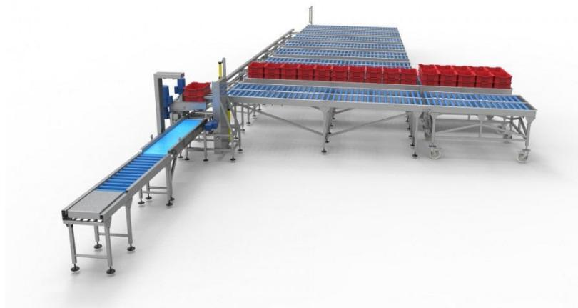
Perangkat otomatis untuk menyortir peti kemas dengan dua ukuran berbeda terdiri dari sabuk konveyor pemasukan peti kemas, tiga pendorong, dan dua sabuk Konveyor pelepasan. Setiap sabuk konveyor mengumpulkan sebuah paletiser.
